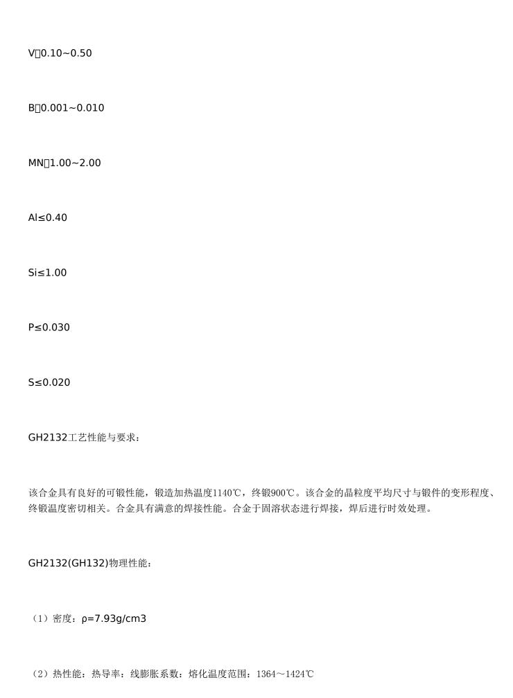
□GH2132(GH132)主要特性□GH2132(GH132)合金是Fe-25Ni-15Cr基高温合金,加入钼、钛、铝、钒及微量硼综合强化。在650℃以下具有高的屈服强度和持久、蠕变强度,并且具有较好的加工塑性和满意的焊接性能□GH2132(GH132)合金铬、镍含量相对较低,故抗氧化的温度只约800%,但是含弥散强化相形成元素(v□A1□Ti)量相对较高,在固溶体基体上可形成化合物强化相,所以常用热处理形式为固溶处理+时效。山西高温合金机械性能高温合金主要是什么材质?国内什么厂家生产?——无锡市乾德特钢有限公司。
